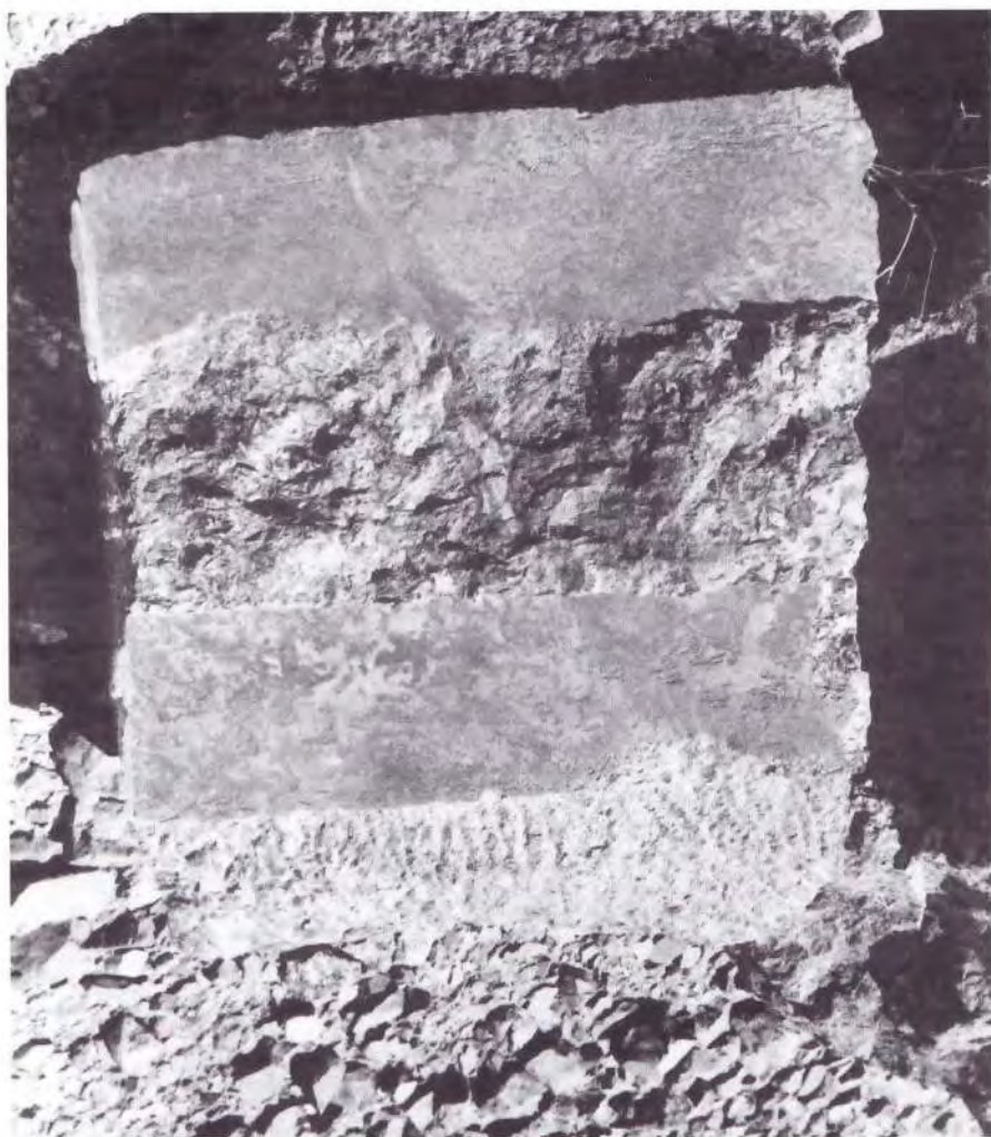
Fig. 7 - Blocco di cava in 'granito della colonna' con i segni di scalpello (sabbia) e i segni di sega ad acqua e sabbia.
